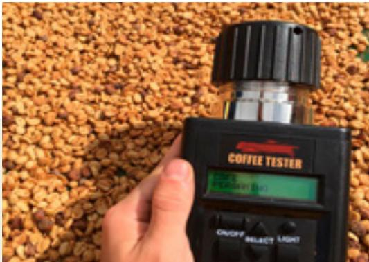
**Figura 1:** Ejemplo de medidor de humedad
